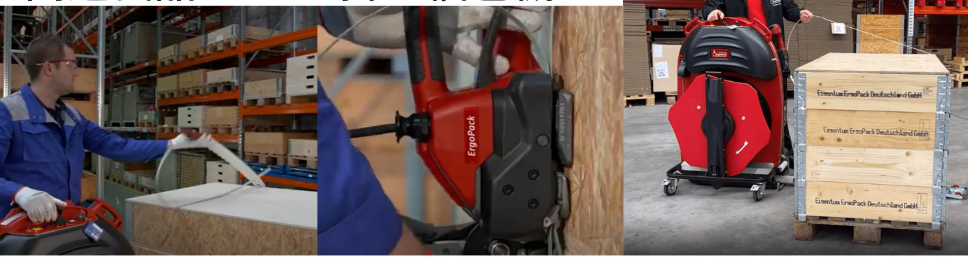
パレットにバンドを通す作業も、腰を曲げずに行えます。 バンドが製品とパレットを機械で一周し、溶着・切断までエルゴパックで完結。 腰痛予防やけが防止に最適なツールです。
