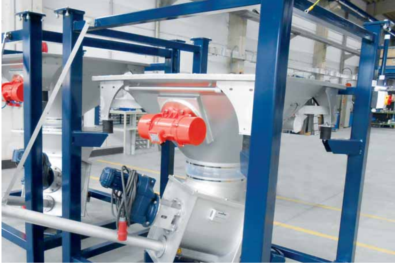
20 振動付き排出ボトムと下流計量スクルーを備えたフレコン排出装置
