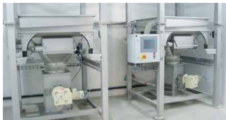
3 EMDE-LIFTを接続したフレコン排出装置
