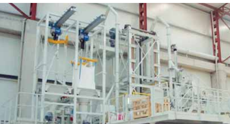
2 バッチ処理でのフレコン排出装置
