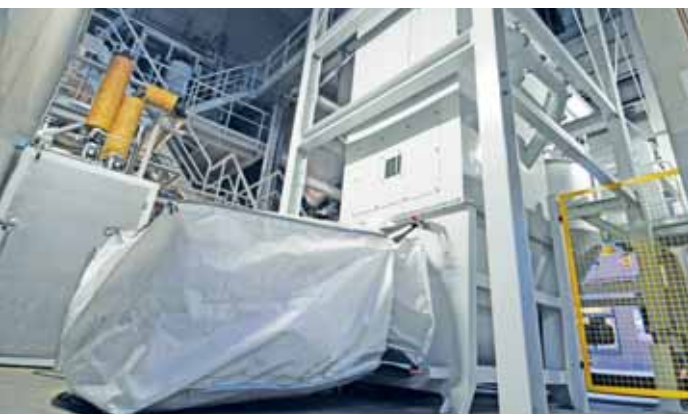
35 フレコン用コンプレッサーによる自動排出システム
